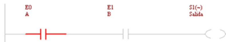
Figura 6. 7 Función Lógica AND (Y) con entrada A en "1" y B en "0".
