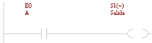
Figura 6. 15 Función Lógica NO Inversora con las entrada A en "0".
