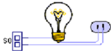
Figura 8. 22 Diagrama de conexión de la terminal de salida
