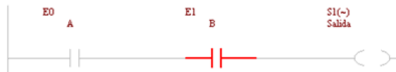
Figura 6. 6 Función Lógica AND (Y) con entrada A en "0" y B en "1".
