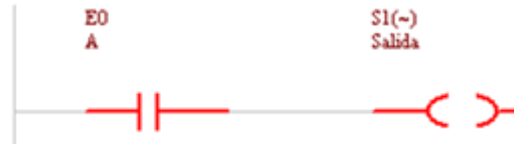
Figura 6. 16 Función Lógica NO Inversora con las entrada A en "1".
