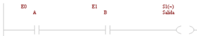
Figura 6. 5 Función Lógica AND (Y) con las entradas A y B en "0".
