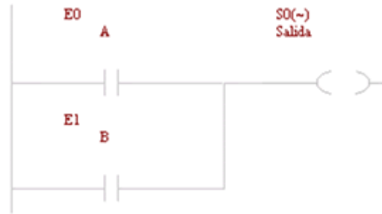
Figura 6. 9 Función Lógica OR (O) con las entradas A y B en "0".
