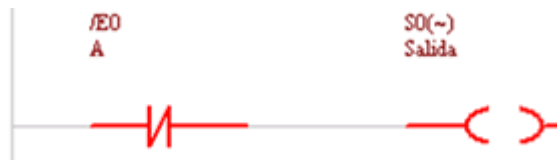
Figura 6. 13 Función Lógica Inversora (NOT) con las entrada A en "0".
